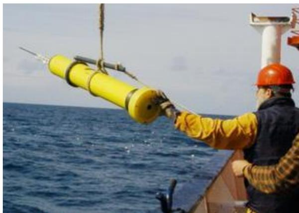
**Figura 2.12** Veículo autônomo aquático *Argo Float*.
