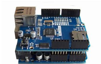
Figura 28 – Arduino UNO com um Ethernet Shield.
