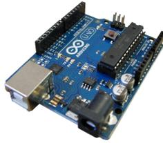
Figura 27 – Placa de prototipação Arduino UNO.
