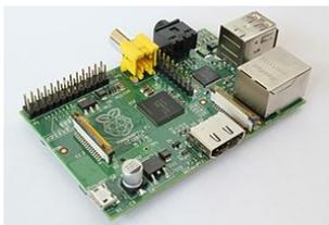
Figura 22 – Imagem do Raspberry Pi modelo B
