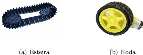
Figura 12 – Exemplos de atuadores utilizados na robótica
