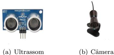
Figura 11 – Exemplos de sensores utilizados na robótica
