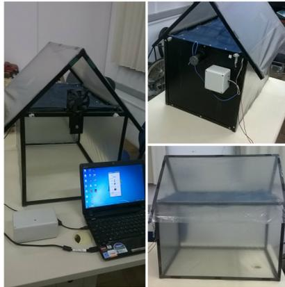
Figura 27 – Mini abrigo de cultivo utilizada para os testes
