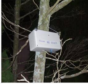
Figura 23 – Teste de estresse, módulo de sensoriamento em ambiente externo.
