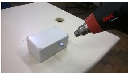
Figura 25 – Soprador térmico utilizado para elevar a temperatura.
