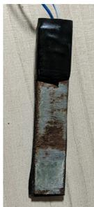
Figura 34 – Chapa oxidada no experimento.
